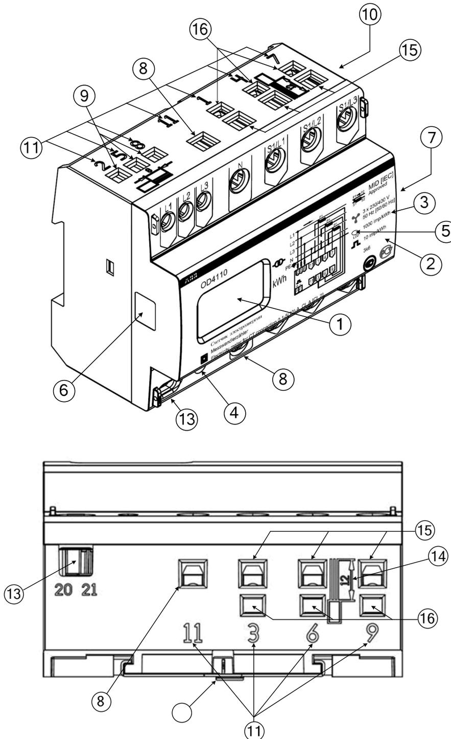
Fig. 2-1 Meter parts
